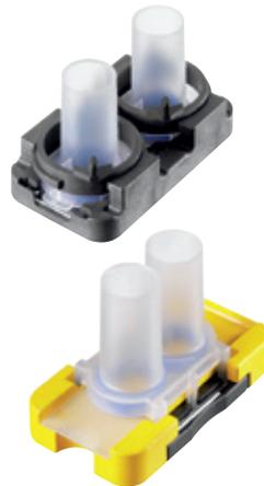
Para examinar 1 millón de células, p. ej. en la búsqueda de células cancerígenas, son especialmente adecuadas las superficies de sedimentación de dos cámaras de 8 ml (2 x 240 mm<sup>2</sup>).
